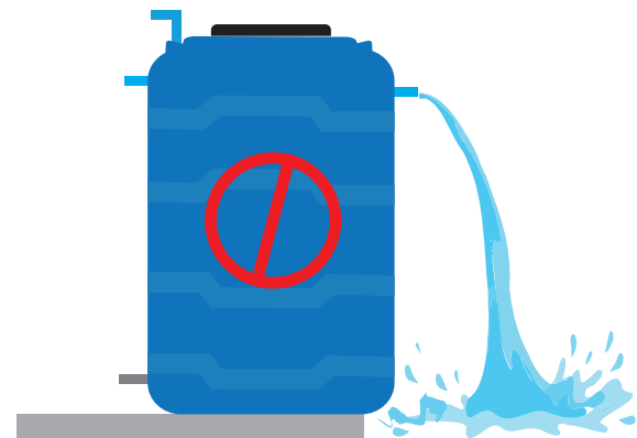
Revisar la base del estanque: longitud de derrame inadecuado.
